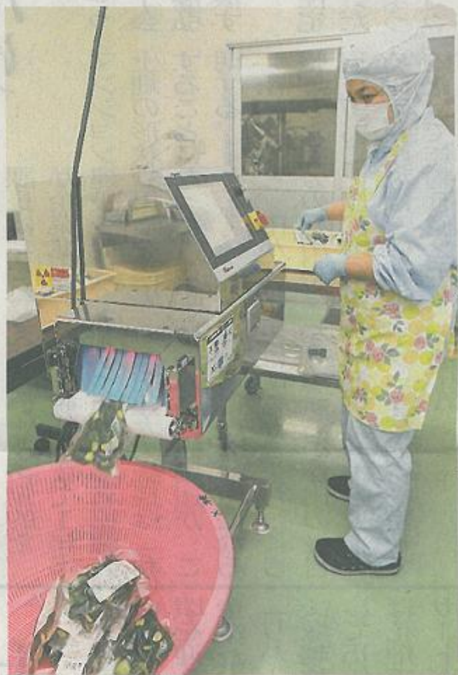
製造した漬物などに異物が混入していないかエックス線検査をする「たべたがり」工場。新たな雇用創出が期待されている＝長岡市小国町下新田
